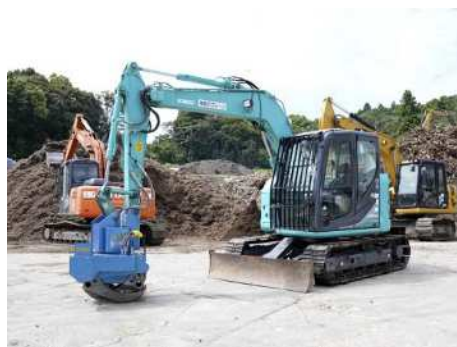
0.25 バックホー（グラブ装置付）6 台
